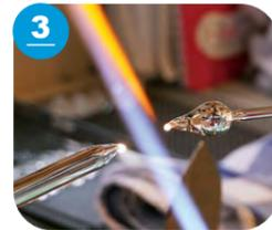
3 しずく形にポンテ竿(細いガラス棒)を付け、ガラス棒から切り離します。
